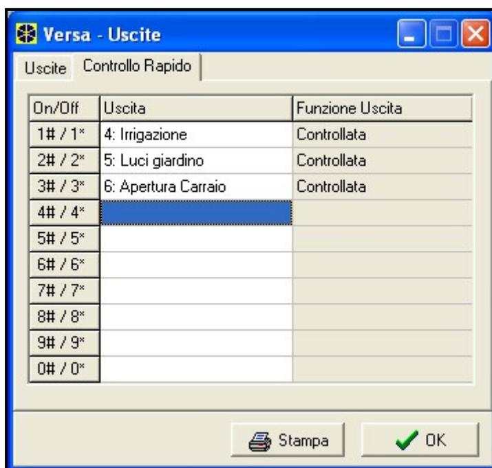
Fig. 12. Assegnazione delle uscite ai tasti della tastiera per il loro controllo rapido (esempio di programmazione).
