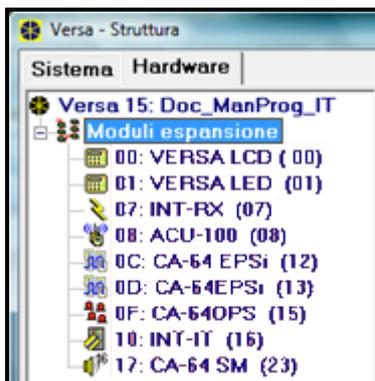
Fig. 13. Elenco dei dispositivi identificati dalla centrale mostrato nella scheda “Hardware” nella finestra “VERSA – Struttura” (esempio di programmazione).
