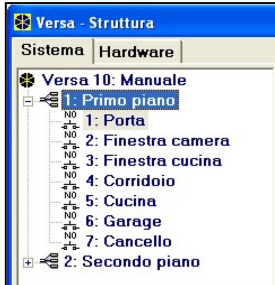
Fig. 7. Elenco delle partizioni e delle zone nella struttura ad albero nella scheda “Sistema” della finestra “VERSA – Struttura” (esempio di programmazione).
